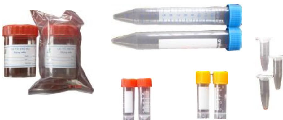
Hình 59: Các lọ và tube như thế này nên được sử dụng để lấy và giữ các mẫu thử làm xét nghiệm PCR/qPCR
