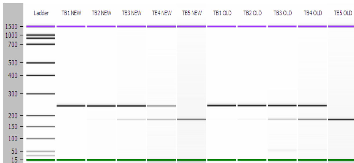
Hình 60: Kết quả kiểm tra chất lượng bộ thuốc thử NK DNAPREP-BOOM do công ty Nam Khoa sản xuất. Đối tượng dùng để kiểm tra bộ thuốc thử là huyền dịch vi khuẩn M. tuberculosis TB1 chứa 10.000 tế bào vi khuẩn/ml được pha loãng theo hệ số 10 để có 1,000 tế bào vi khuẩn/ml (T2), 100/ml (T3), 10/ml (T4), và 1/ml (T5). Phương pháp kiểm tra là sử dụng bộ thuốc thử NK DNAPREP-BOOM cần kiểm tra và bộ NK DNAPREP-BOOM được sản xuất trước đó để thực hiện tách chiết trên các huyền dịch vi khuẩn đã pha loãng này, thể tích huyền dịch để tách chiết là 100 \mu l, rồi lấy 10 \mu l dịch tách chiết để chạy PCR phát hiện M. tuberculosis . Phát hiện DNA của M. tuberculosis có trong dịch tách chiết qua điện di phát hiện sản phẩm khuếch đại 249bps. Kết quả cho thấy cả hai bộ thuốc thử NK DNAPREP-BOOM mới và cũ đều đạt LOD là 1 tế bào vi khuẩn M. tuberculosis trong thể tích tách chiết.
